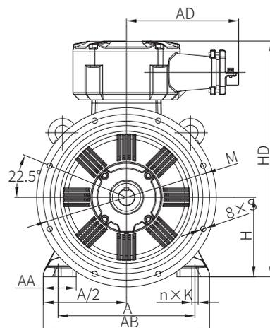
机座带底脚、端盖带凸缘<sup>a</sup>的电动机 (B35)80~355
