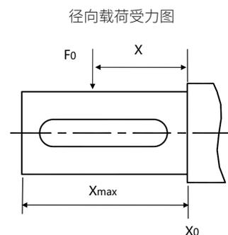
注：当负载有较大的径向力和轴力，且轴伸为非标长轴伸，280、315、355 机座 4P/6P 电机需要使用短圆柱轴承，并建议轴承寿命重新校核、轴承型号重新选配。
