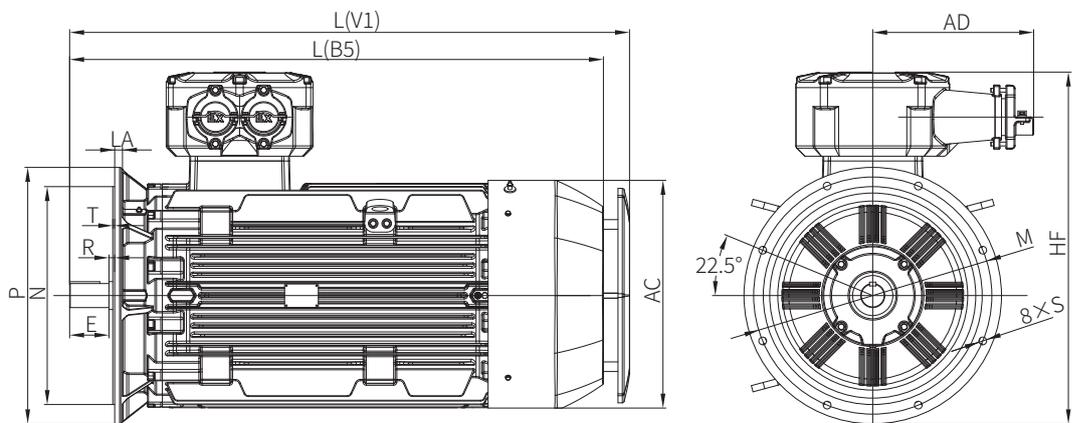
机座带底脚、端盖带凸缘<sup>a</sup>的电动机 (B5、V1) 80~355
