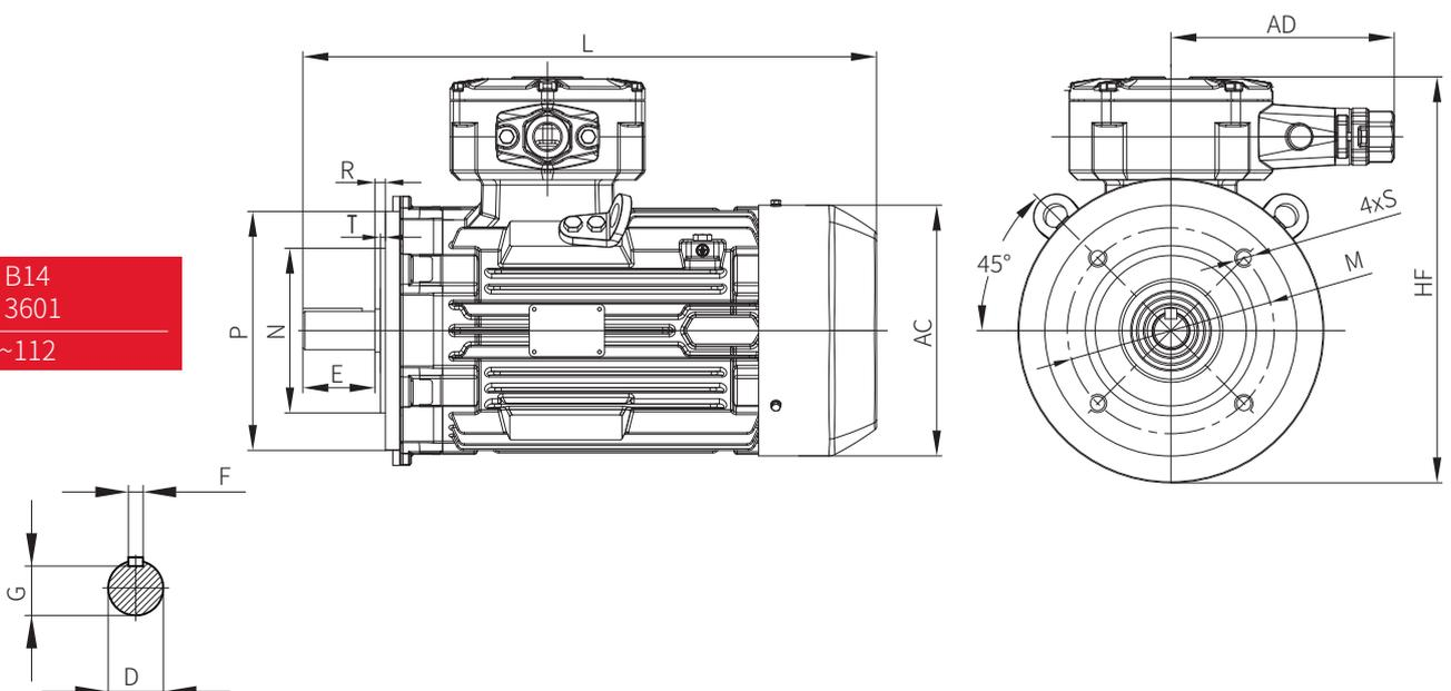
**机座带底脚、端盖上带凸缘（螺孔）的电动机 (B34)80~112**
